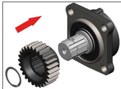
1 - Montieren Sie das Zahnrad auf den Pumpen welle versorgt und sicher mit Seeger-Ring.
