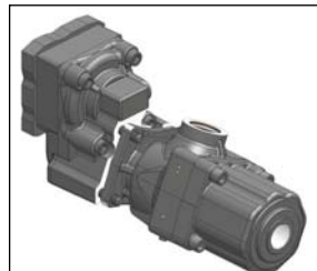
2 - Die Pumpe 10 mm vom Nebenantrieb entfernen..
