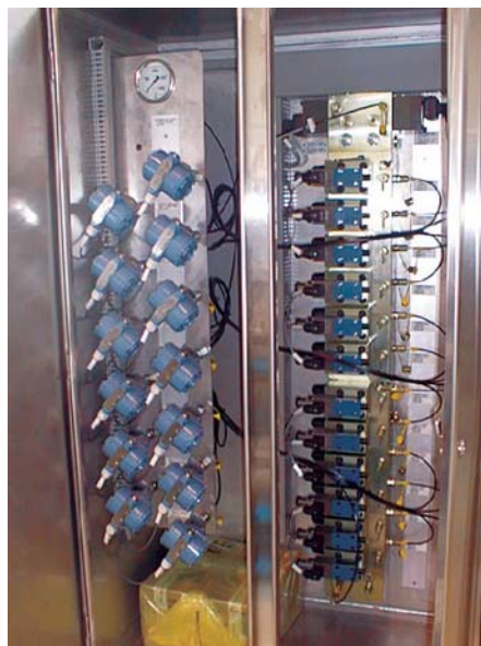
Kuva 25. Venttiilistö toteutettuna perinteisillä komponenteilla (vasen kuva) ja nykyhetken uusinta tekniikkaa vastaavilla (oikea kuva, venttiiliin liitetty digit. elektroniikka ja venttiilin sisäinen painelähtin) /23/.
