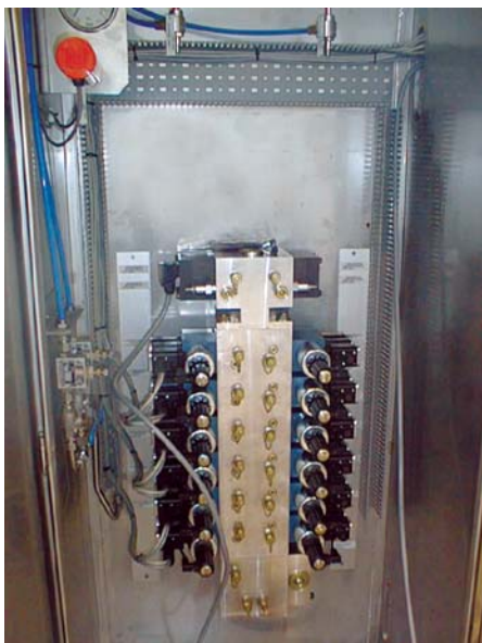
Kuva 25. Venttiilistö toteutettuna perinteisillä komponenteilla (vasen kuva) ja nykyhetken uusinta tekniikkaa vastaavilla (oikea kuva, venttiiliin liitetty digit. elektroniikka ja venttiilin sisäinen painelähtin) /23/.
