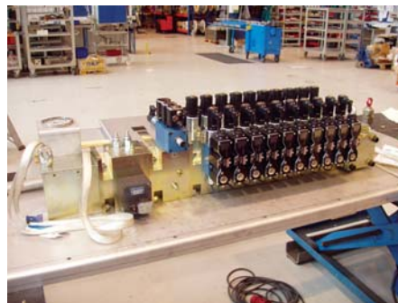
Kuva 24. Osalohkoista koostuva järjestelmän ryhmäpohjalaatta kahden eri valmistajan venttiileille sovellettuna /23/.
