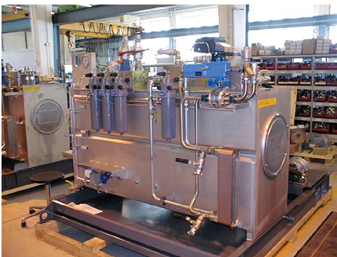
Kuva 19. Lohkoihin keskitetty koneikon hydraulikka /23/.
