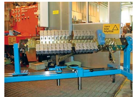
Kuva 24. Osalohkoista koostuva järjestelmän ryhmäpohjalaatta kahden eri valmistajan venttiileille sovellettuna /23/.
