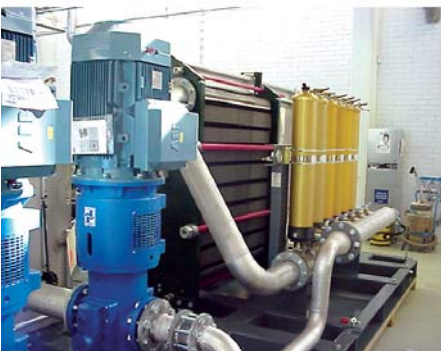
Kuva 21. Putkityön ja liitosten vähentämiseksi on siirrytty yläkuvan rakenteesta alakuvassa olevaan rakenteeseen /23/.
