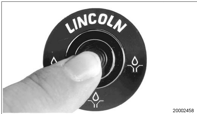
PCB 9 Touche pour le déclenchement externe d'un cycle de lubrification supplémentaire
