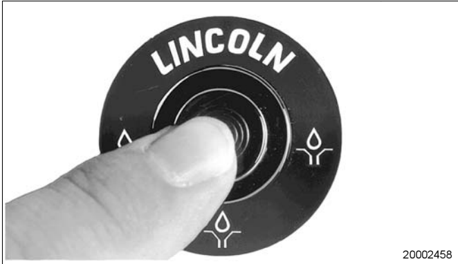
PCB 9 Pulsante per attivazione di ciclo di lubrificazione supplementare
